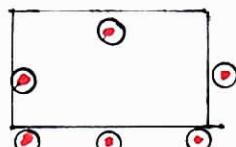
Cadre avec deux accroches pour la fixation à une 6 pinspot plus trois poulies sont fixées au cadre. Le poids total est de 6 kg Le cadre est fourni par la Cie
